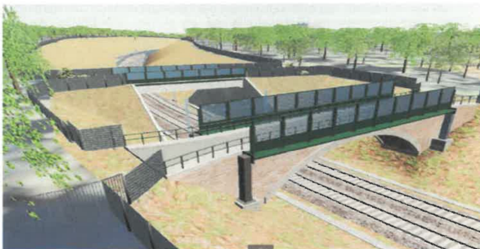
Schéma de principe - Pont-route des Volières (en premier plan) / Passage à faune (en second plan) (source : DAE, pièce E)
